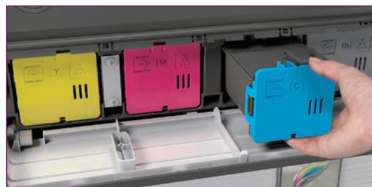
Tonerkassetterna matas ut automatiskt först när de är helt tömda.
